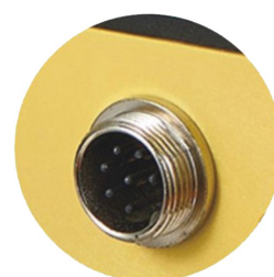
ورودی کنترل سیگنال
